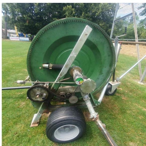
Système de traction mécanique
